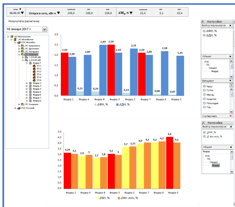
Рисунок 8 - Экранная форма ПТК «РТП 3» системы мониторинга (динамика допустимого и фактического небалансов, фактических технических потерь и минимально возможных технических потерь)
