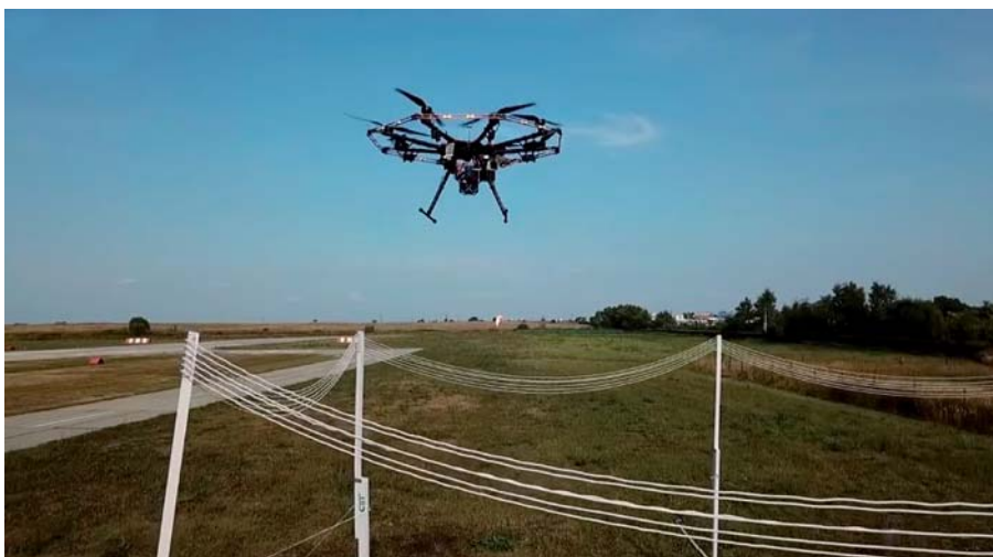
Рис. 16. GET Distant Wireless Power — инновационная система беспроводной индукционной подзарядки одновременно нескольких дронов без посадки на землю
